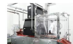
利用分光技术和AI，使得有机物的检测成为可能。(与 AOHATA Corporation 共同开发的“Jam Fruit Spread 用异物检测装置”可在果酱制造过程中自动检测出异物和杂质。)
