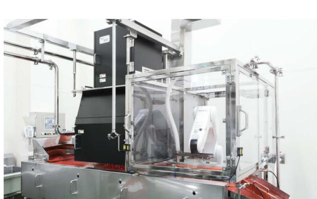
利用分光技术和AI，使得有机物的检测成为可能。（与AOHATA Corporation共同开发的“Jam Fruit Spread用异物检测装置”可在果酱制造过程中自动检测出异物和杂质。）
