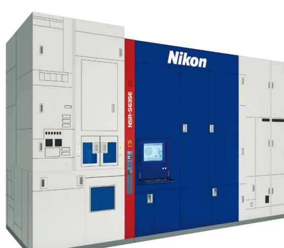
缩小电路图尺寸，使用超分辨率透镜将其投射到晶片上。
