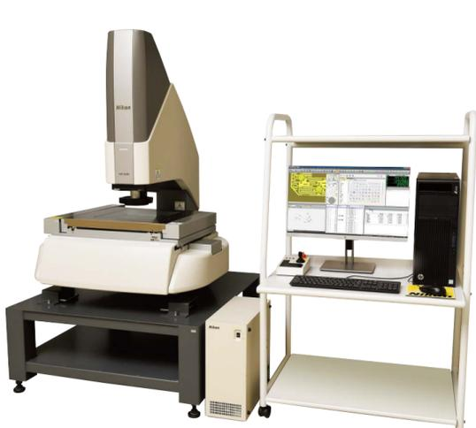
NEXIV系列高精度设备，通过高精度工作台操作和高性能光学系统，进行非接触式高速精准的测量。
