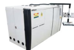
高功率X射线源可用于检查飞机涡轮叶片,以及用于汽车制造的大型铸件。
