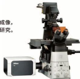
※搭载倒置科研级显微镜“ECLIPSE Ti2-E”
