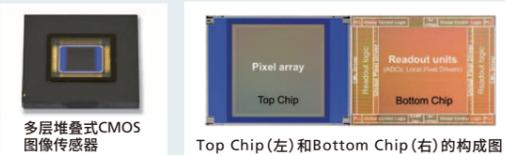
Top Chip (左) 和 Bottom Chip (右) 的构成图
