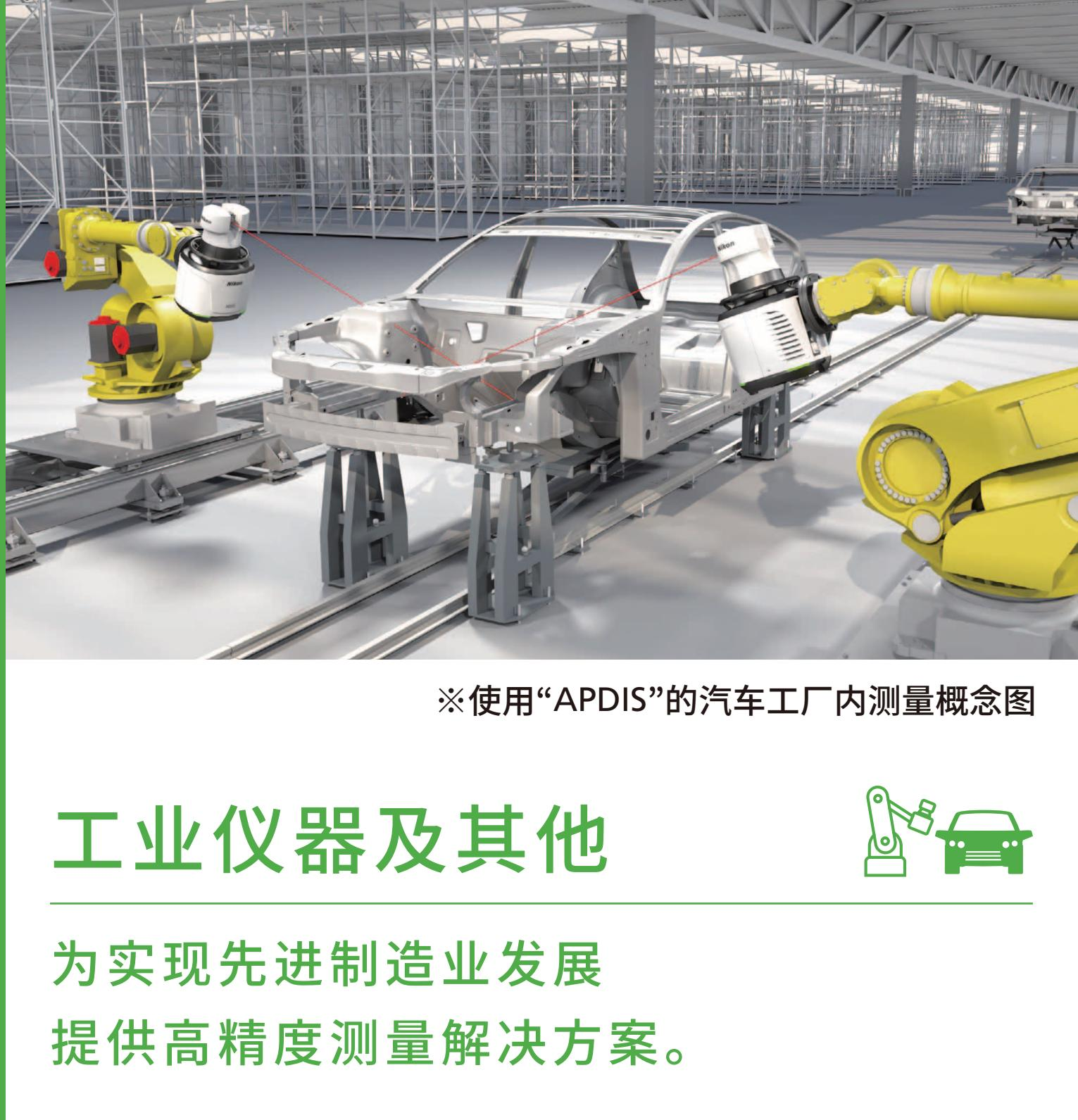
※使用“APDIS”的汽车工厂内测量概念图
